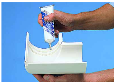
17. Rohy (kat. č. 8 a 9). Naneste dva proužky lepidla o šířce 5 mm na lepenou polovinu rohu, ihned namontujte. Hranu okapového žlabu dorazte až ke značce v rohu.
