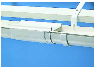
20. Dilatační tvarovka (kat. č. 10) Je-li vzdálenost mezi dvěma výstupy větší než 18 m anebo mezi dvěma rohy více než 8 m je nutno namontovat dilatační tvarovku (návod je součástí dodávky). Pozor! Dilatační tvarovka se nelepí!
