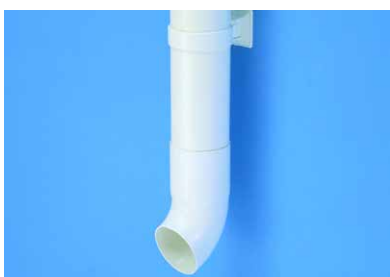
25. Koncové koleno (kat. č. 27) Pro volný výstup použijte koncové koleno, které přilepíte na odpadní trubku.
