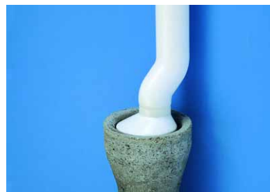
24. Zděř vpusti (kat. č. 23 a 24). Koncové „S“ - koleno (kat. č. 22) zasuňte volně na trubku, kterou nechte o 100 mm delší. Na koncové „S“ koleno nasadte zděř vpusti. Celý komplet spusťte do hrdla kanalizace a oběma díly nastavte odpadní trubku tak, aby byla kolmá.
